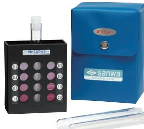
DPD法簡易型遊離残留塩素測定器
