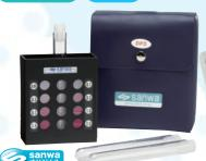
DPD法簡易型遊離残留塩素測定器
